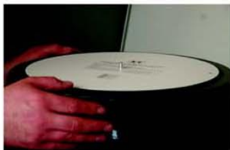
Step5：將皮帶套上，輕輕旋轉邊緣，讓皮帶導入定位。
