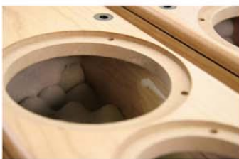
● 下/音箱內部和外部，都必須貼上相同材質的木紋，避免使用時間久了以後外表木皮裂開。
