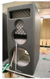
●組裝前的MB2的音箱，可以發現和OB1裡面的阻尼物又不同。
