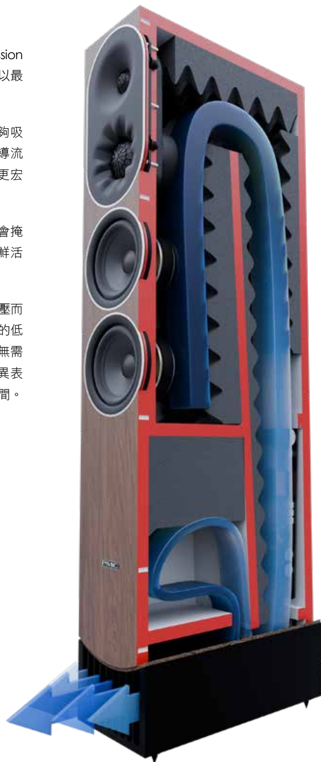
截面圖：顯示ATL™與LaminairX之配置，及低頻空氣流之運動方向
